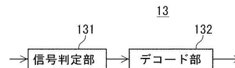
図3 図1中のデジタル処理モジュールの一実施形態の概略ブロック図
