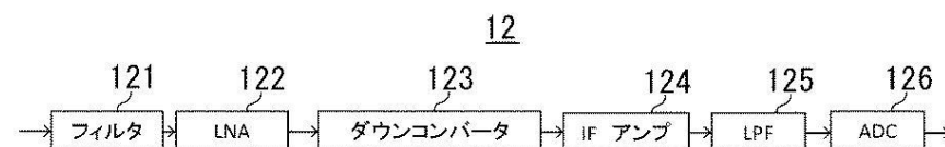
図2 図1中のアナログフロントエンドの一例のブロック図
