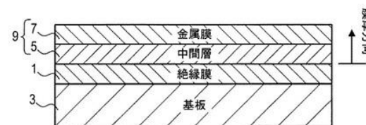
(a) 実施例1の積層膜を模式的に示す説明図
