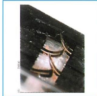
図2 制作したSMAアクチュエータの側面写真（6個の一括制作）
