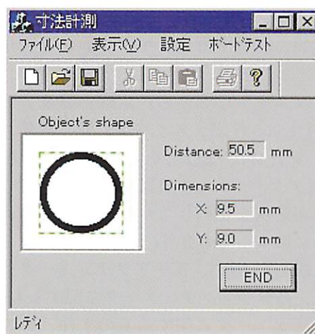
図2 テストパターン（外径9mmの円）の寸法計測結果
