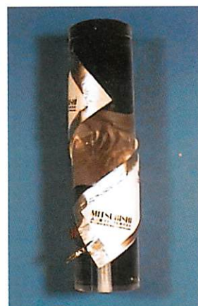
図2 試作したテープ状の形状自在二次電池
