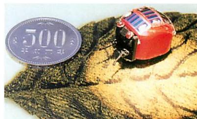
写真2 光エネルギー供給によるアクチュエータ走行
