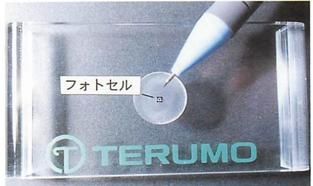
写真1 試作したフォトセル（受光面0.5mm×0.5mm）
