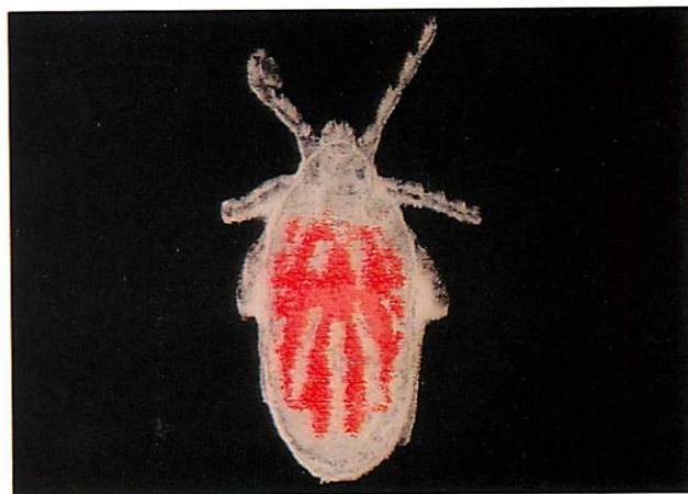
図3 断面観察像から構築した“だに”の像
