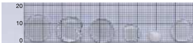
図1. 架橋MPCポリマーゲル体積のアルコール組成依存性 左からエタノール組成、0、20、40、60、80、100%
