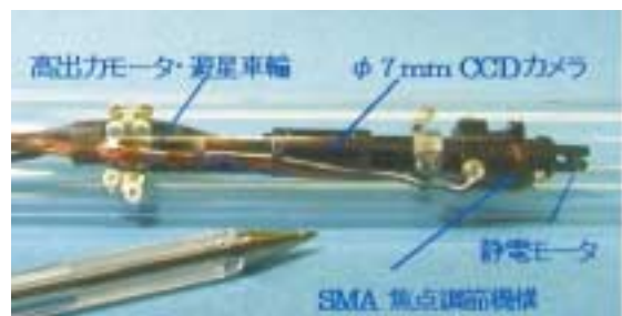
図3 配管内検査ロボットへの応用例
