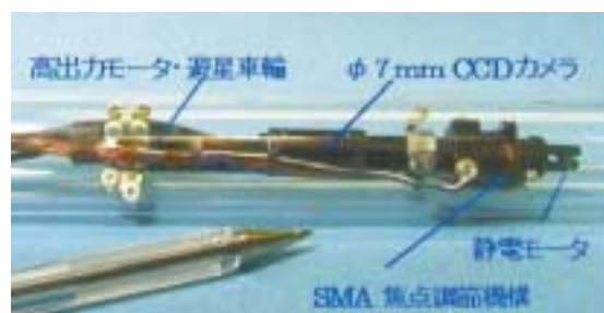
図3 配管内検査ロボットへの応用例
