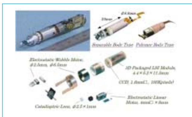
図1 管内自走環境認識システムとマイクロ視覚
