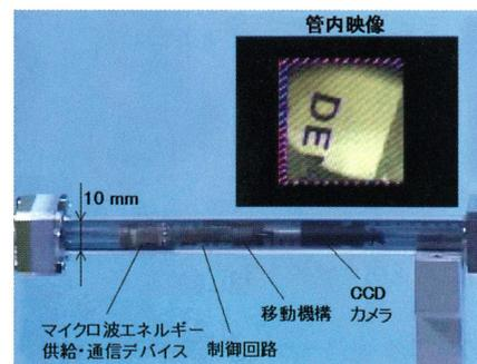
図2 ワイヤレスによる管内移動及び撮像動作
