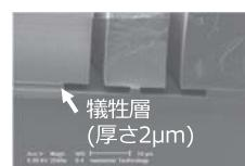
AlN圧電薄膜スパッタ成膜 → 圧電カンチレバー型センサ開発(国プロ成果\*)
