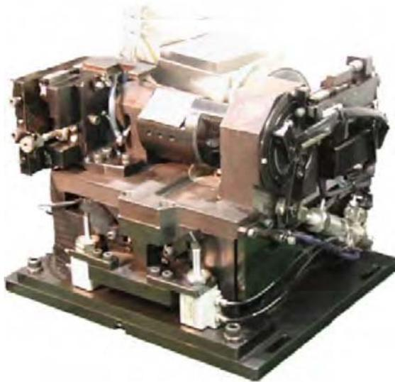
図 3. 1. 7 ミニ生産システム(ミニ円筒研削システム)
