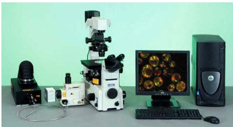
図 3. 1. 12 高速共焦点レーザー顕微鏡 Model CSU22
