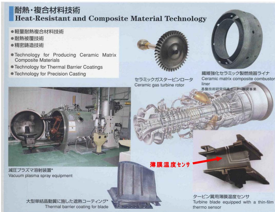
図 3. 1. 11 タービン翼温度測定用薄膜温度センサ
