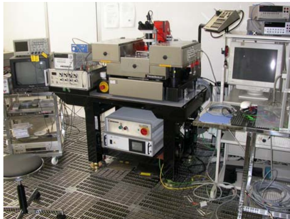
図 3-4-51 測定系の写真。プローバは 8 インチオートプローバー Süss Microtec PA200
