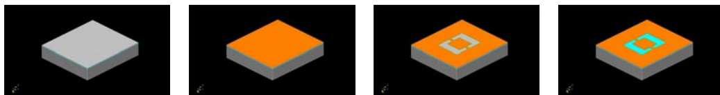
SOI 基板→GND 電極用金属成膜→可動部・ヒンジ形成→エッチング
