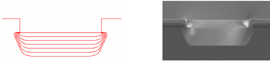
(a) 流量 50sccm,放電パワー50W,圧力 5Pa
