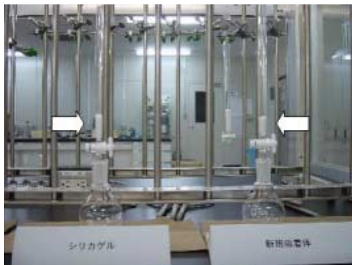
図3 1 シリカ・メソ多孔体のダイオキシン吸着実験
