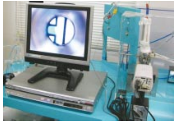
超臨界混合観察セルシステム (産業技術総合研究所/コンパクト化学システム 研究センター相澤主任研究員との共同開発製品)
