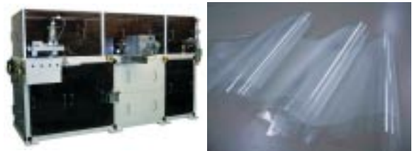
Roll to Roll UVナノインプリント装置と転写フィルム
