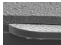
図4 SOI犠牲層エッチング例：シリコン共振器 (SiTime様ご提供)
